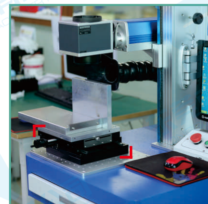
产品型号: TMY2020 轴 向: XY轴 应用场景: 激光打标机工件位置的调整
